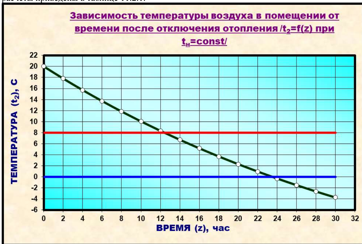
Рисунок 10.2.1 – Зависимость температуры воздуха в помещении от времени после отключения отопления при наружной t_{\text{наруж.}} = -10^{\circ}\text{C}
