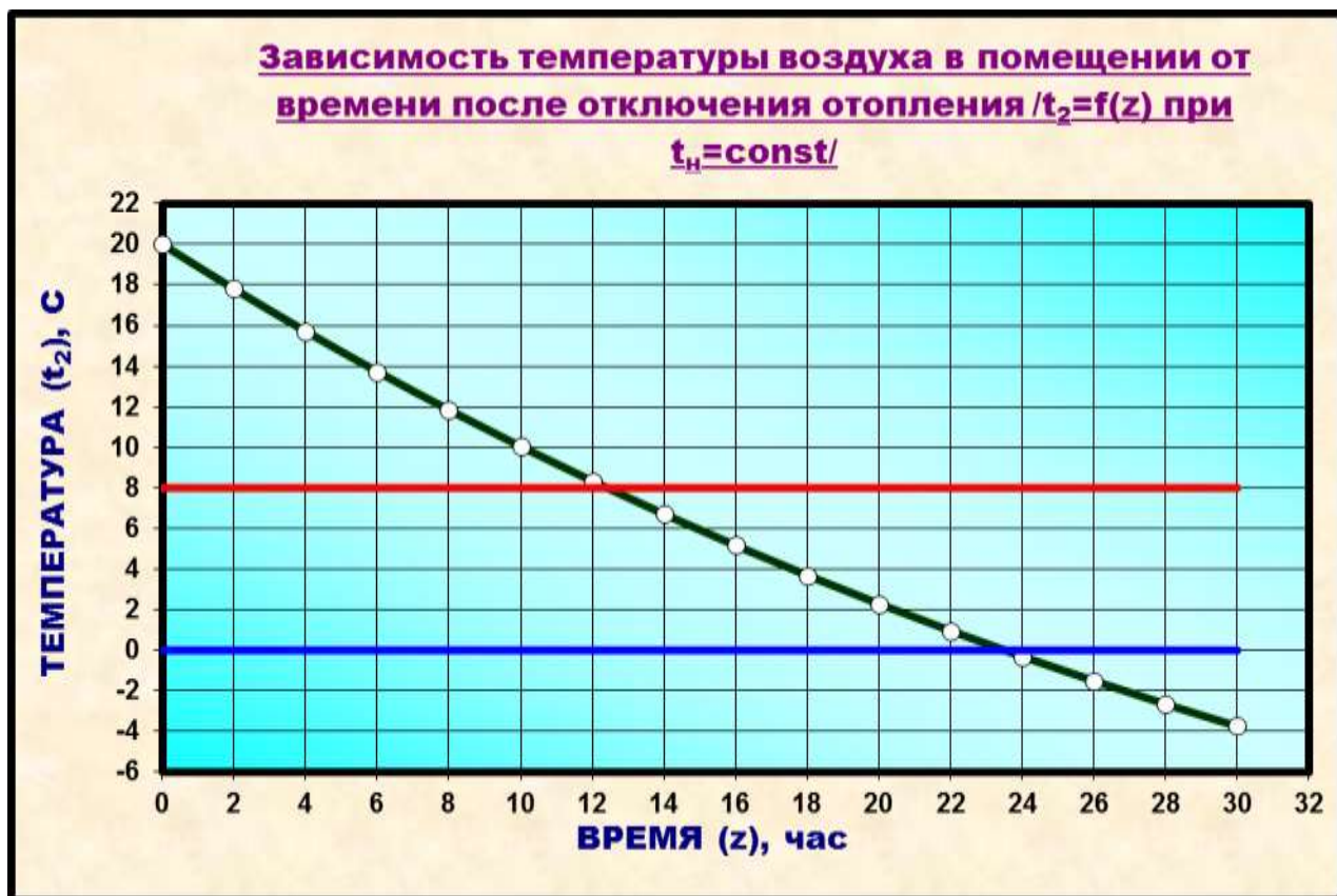
Рисунок 11.2.1 – Зависимость температуры воздуха в помещении от времени после отключения отопления при наружной t_{нар.ж.} = -10^0C
